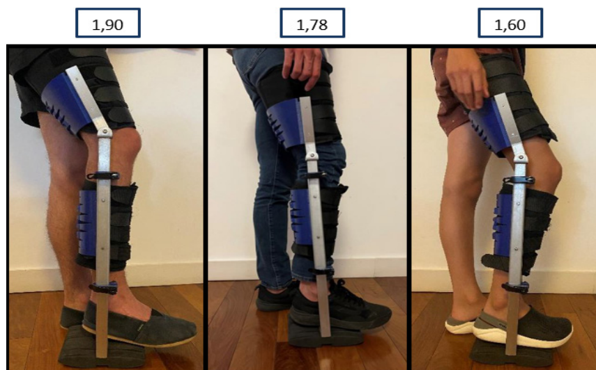
Figura 31. Maqueta en uso para usuarios de diferentes alturas (metros)
