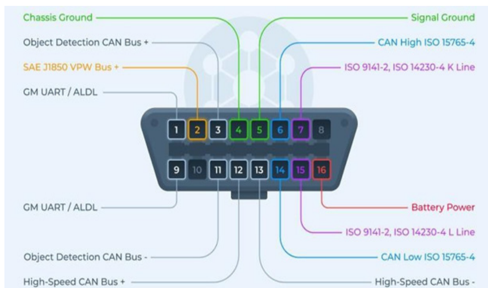
Figura 2. Designación de pines del puerto OBDII con uno o dos Bus CAN (9)
